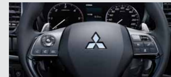
בקרת שיוט CRUISE CONTROL הנשלטת מגלגל ההגה עם מגביל מהירות. שליטה מגלגל ההגה על דיבורית BLUETOOTH ומערכת השמע**
